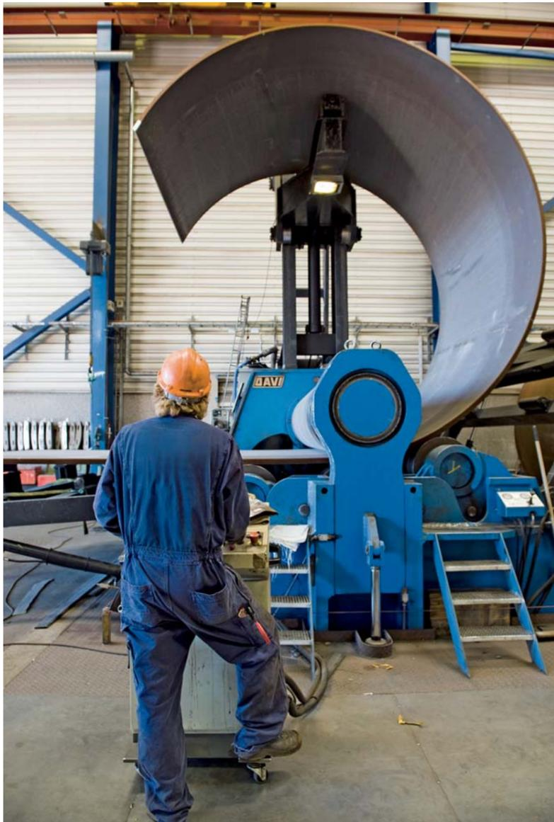
ARBEITER BIEGEN STAHLPLATTEN ZU RINGEN, ALS SEIEN SIE AUS PAPPE. DANN WERDEN SIE ZU LANGEN FUNDAMENTEN ZUSAMMENGESCHWEISST.
